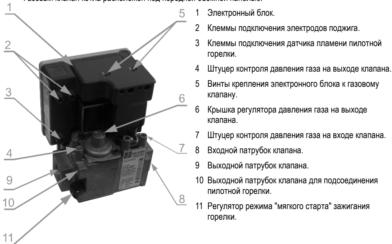
Рисунок 10. Газовый клапан котла с автоматикой.
